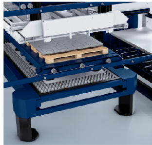
同步上料机构确保快速的上下料过程
