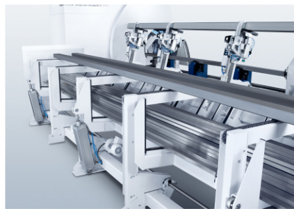
安装在TruLaser Tube 7000的摆动式输送装置，可实现小批量或特殊型材的上料
