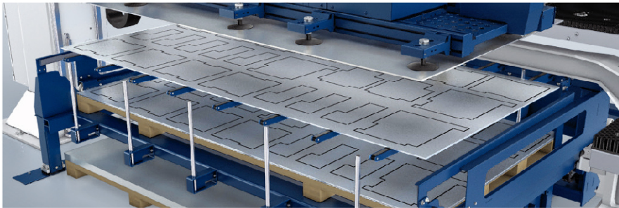
通过使用防划伤的铁叉可实现微链接板材的防划伤出料
