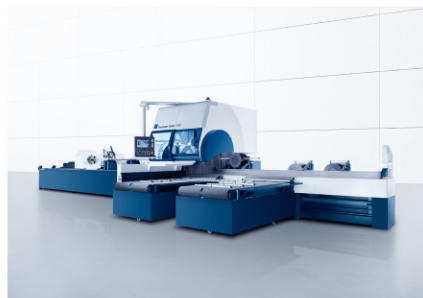
全自动设备TruLaser Tube 7000：上料、下料、分拣和残料处理
