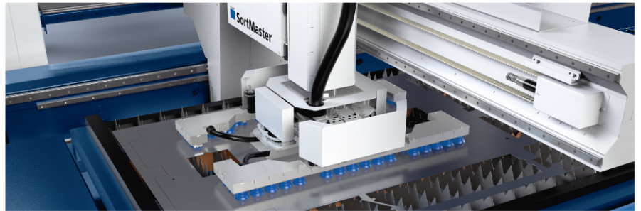
智能功能：监控工件是否正确分离，如没有分离，则可通过抓取头的振动进行额外分离
