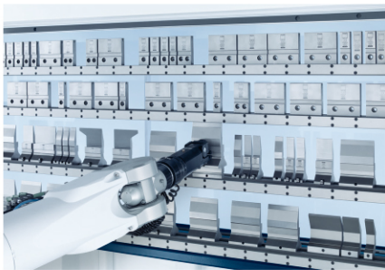
ToolMaster Bend实现全自动模具设定
