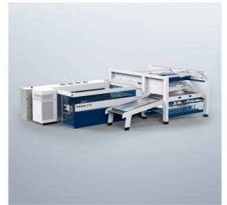
LiftMaster Compact与TruLaser3030纵向工作台和PartMaster相连
