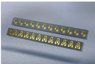
Bild 1: VCSEL und Photodioden als 1x1, 1x4 oder 1x12 Arrays
