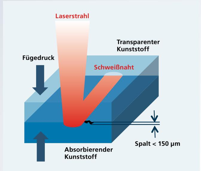
Um eine dauerhafte Verbindung zu erreichen, muss der aufgeschmolzene Kunststoff vollständig erstarren. Deshalb muss die Vorrichtung die beiden Fügepartner auch nach dem eigentlichen Schweißvorgang noch für eine gewisse Haltezeit aufeinanderpressen.
