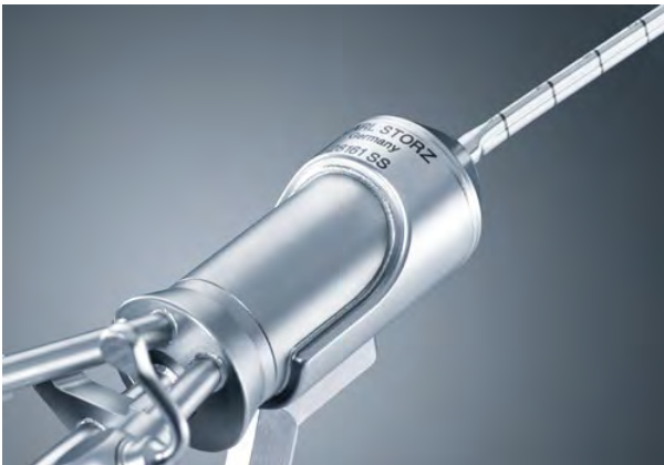
Anlassbeschriftung auf abgerundeter Oberfläche.
