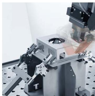
Bearbeiten Sie mittlere und größere Bauteile flexibel in einem System: Der automatisierte Roboter beherrscht neben LMD auch weitere Laserschweißverfahren.
