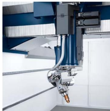
Kompakt und modular aufgebaut wie die TruLaser Cell 3000 bietet deren „große Schwester“ neben mehr Leistung auch mehr Bearbeitungsraum für größere Bauteile. Einfach und flexibel wechseln Sie von LMD auf Laserschneiden und -schweißen.
