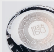
Das per UKP-Laser gravierte Editionslogo im Gehäuseboden aus Platin PT950.
