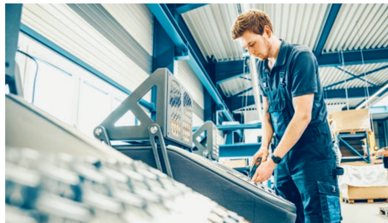
Kraftvoll und präzise: Die Aluminium-Riffelbleche für die EGYM-Geräte schneidet und formt die TruMatic 7000 kratzerfrei und in bester Qualität.
