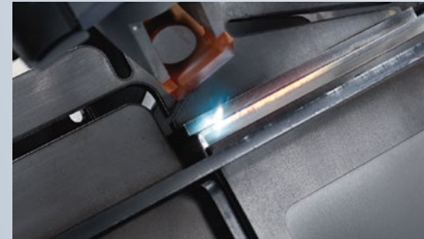
Schweißen einer Batteriewanne, Material: Aluminium 6000
