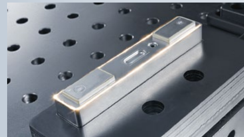
Can-Cap-Schweißen einer Batterie, Material: Aluminium
