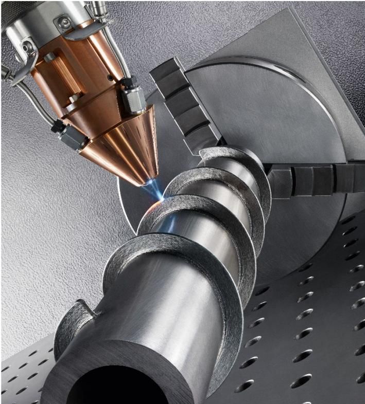
Erschließen Sie neue Märkte mit Laserauftrag-schweißen. Beschichtung, Reparatur und additive Fertigung – mit dem Technologiepaket DepositionLine erhalten Sie die individuelle Lösung aus Strahlquelle, Pulverförderer, Optiken und Düsen.
