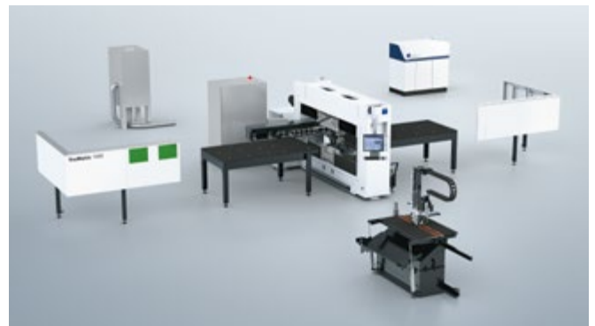
Durch Nachrüstung des Lasers und weiterer Komponenten wird aus der TruPunch 1000 die TruMatic 1000 fiber.
