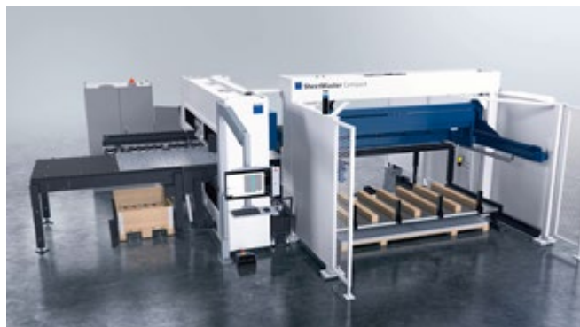
SheetMaster Compact für automatisiertes Beladen.
