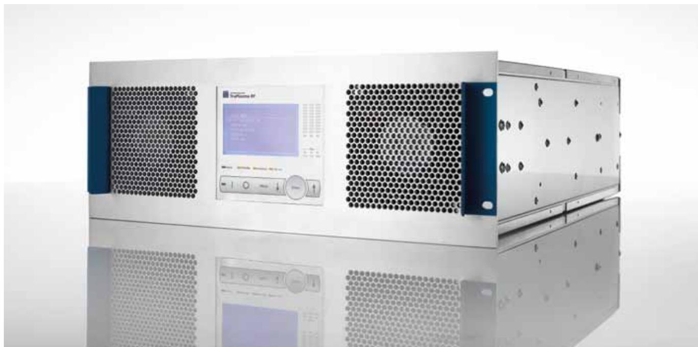
Die einzigartige Effizienz und Stabilität der TruPlasma RF Serie 3000 beruhen auf zwei sich ergänzenden, hochmodernen Eigenschaften: der Class-D-Technologie, einer energieeffizienten Methode zur Stromumwandlung, sowie dem von TRUMPF Hüttinger patentierten CombineLine-Koppler, der für besonders stabile Prozesse sorgt und Schäden durch reflektierte Leistung verhindert.
