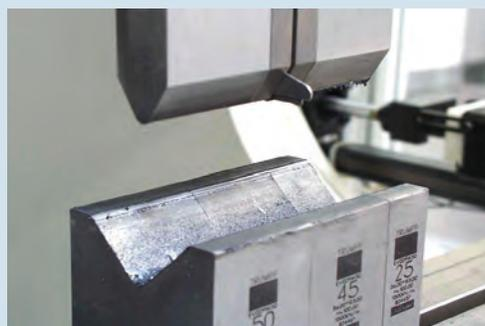
Frühzeitige und regelmäßige Pflege der oben beschriebenen Elemente mit einem ölgetränkten Lappen erhöht die Standzeit und wirkt sich positiv auf die Genauigkeit der gekanteten Teile aus. Den Reinigungsintervall bestimmt dabei immer der Maschinenbediener.
