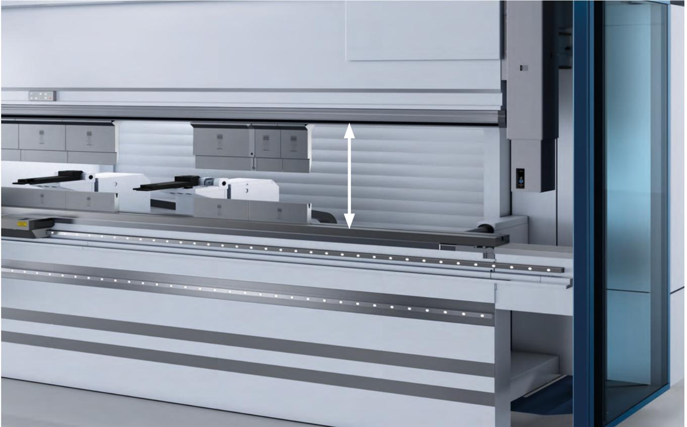
Die Einbauhöhe ist der maximale Abstand zwischen Oberwerkzeugaufnahme und Unterwerkzeugaufnahme (siehe Pfeil oben).
