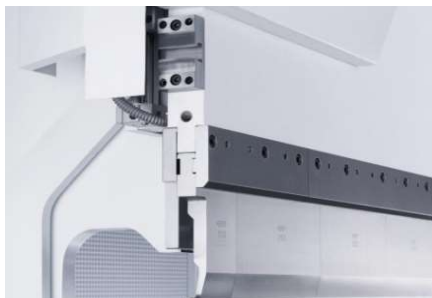
EHT manuell - 26 mm Max. Belastung 3.000 kN/m
