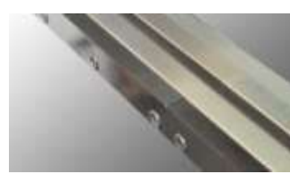
TRUMPF manuell - 13 mm Max. Belastung 3.000 kN/m
