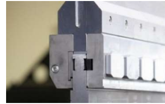
EHT hydraulisch - 26 mm Max. Belastung 6.000 kN/m
