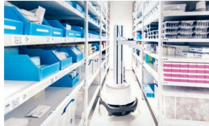
**Ständig im Einsatz:** Mobile Roboter unterstützen die Laborarbeit und transportieren zum Beispiel Verbrauchsmaterial von Arbeitsstation zu Arbeitsstation.
