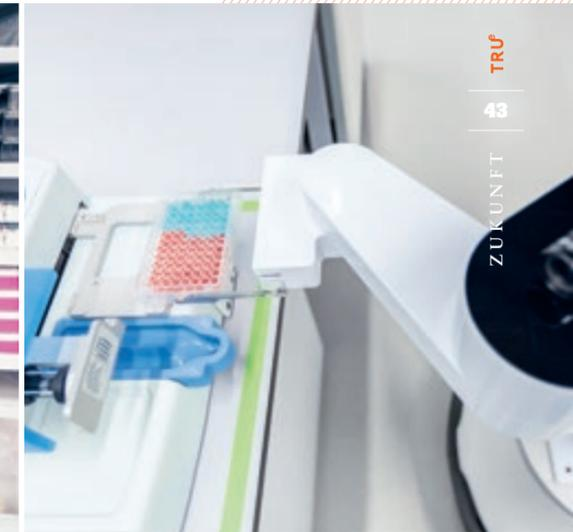
**Autonom:** Kevin unterstützt bei unterschiedlichen Aufgaben im Labor. Hier legt er Ampullen in ein Messgerät.
