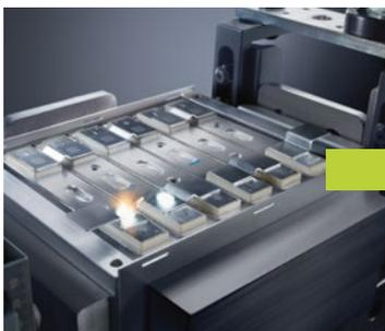
Das Verbinden von Einzelteilen oder Packs erfolgt durch das Busbarschweißen (Busbar = stromführende Schiene) unter Verwendung des TruFiber S.
