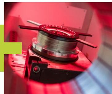
Der TruFiber S wird für hochintegrierte und skalierbare Kupferschweißprozesse eingesetzt und spielt eine entscheidende Rolle für die Qualität der Kontaktierungen in Elektromotoren.
