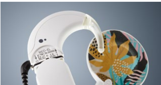
Mit UV-Laser markierter Sprachprozessor mit Antenne.
