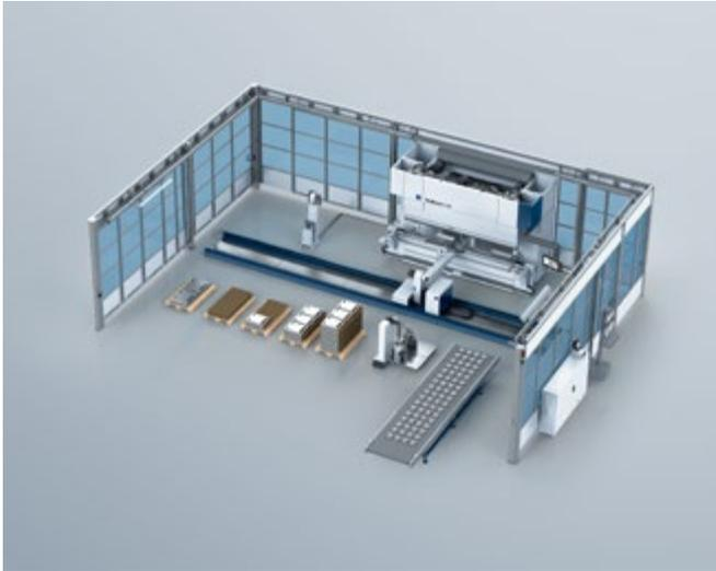
TruBend 5130 mit BendMaster (60), 10 m Fahrbahn, Blechentnahmestation, Förderband und Greiferwechselkonsole.
