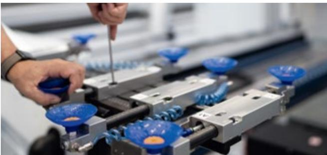
Über Schnellspannverschlüsse passen Sie Ihren Multigreifer in wenigen Handgriffen an.
