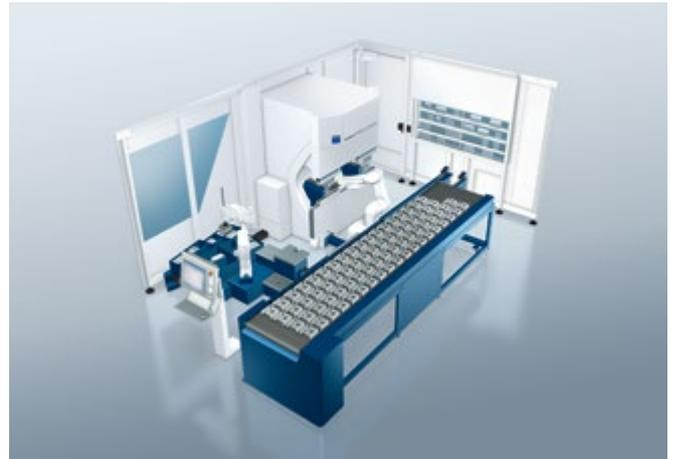
TruBend Cell 7000 mit BendMaster (15), LoadMaster, ToolMaster und Förderband.
