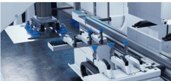
Der Greifer legt das Blech schnell auf der Umgreifstation ab, greift um und nimmt es wieder auf.
