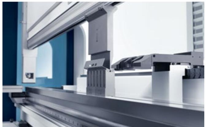
Mit dem RollBend Werkzeug gelingen abdruckarm kurze Schenkellängen sowie Ausformungen und Löcher nahe der Biegelinie ohne Verformung.
