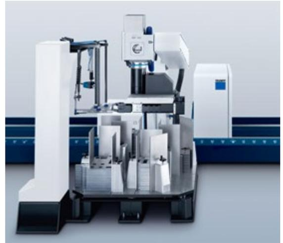
Blechentnahmestation mit Drehtisch
