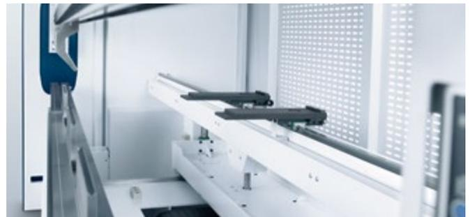
Der 2-, 4- oder 5-Achs-Hinteranschlag macht die Maschine schnell und präzise.
