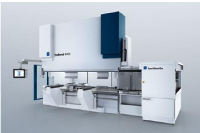
Der ToolShuttle ermöglicht einfaches und schnelles Rüsten schwerer Werkzeuge.
