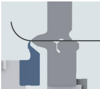
Biegemethode: Radiusbiegung und Falzen
