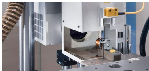
<p>Nejdříve odstranil laser TruMark 5010 izolační lak z měděného drátu. Následně byla kontaktována cívka.</p>
