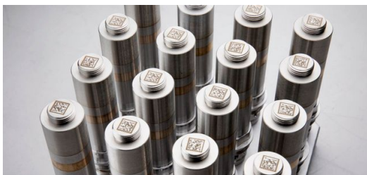
<p>Popisování dílů s Data-Matrix kódy slouží k internímu sledování procesních kroků.</p>
