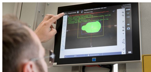
<p>Nová opce UI filtr pro VisionLine Detect zlepšuje detekci charakteristik, tím že díl binarizuje – tedy znázorní výhradně černé a bílé. Oblasti svačování vyčnívají jako ostře konturované bílé plochy.</p>
