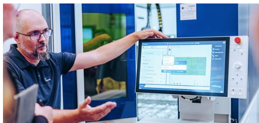
Ovládací panel: Předváděcí technik Uli Schrade demonstruje na displeji, jak jsou všechny bezpečnostní parametry viditelné na první pohled – dříve než laser může být bezpečnost spuštěn.
