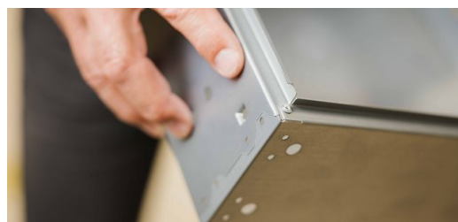
<p>S TruMatic 7000 může Max Knobloch provádět dokonce malá tváření, jako je miskové ražení nebo klipové spoje.</p>
