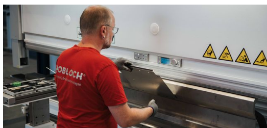
<p>U manuálního ohýbacího lisu TruBend 5130 pracovník zpracovává plechové díly pro zařízení poštovních schránek a zakázkové výrobky.</p>
