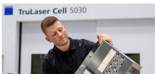
Max Rettenmeier společně se svými kolegy a zákazníky vyvinul nové laserové aplikace. Ty dokážou opotřebované baterie bezpečně rozřezat a odstranit cenné suroviny z fólie baterie.
