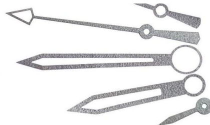
Zuschnitt per Ultrakurzpuls-Laser: Uhrzeiger aus 0,05 Millimeter starkem Edelstahl. Die schlitzförmigen Aussparungen lassen Platz für eine spätere fluoreszierende Beschichtung.
