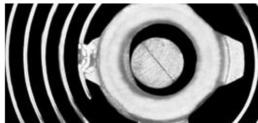
Der Schweißpunkt hat einen Durchmesser von 0,2 Millimetern
