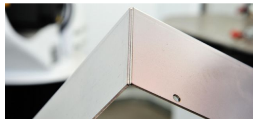
Bei Bauteilen mit Spalten oder ungünstigem Überlapp muss „tolerant“ lasergeschweißt werden. Die TruLaser Weld 5000 bietet diese Möglichkeit mit der Option „FusionLine“. Foto: Peter Klingauf
