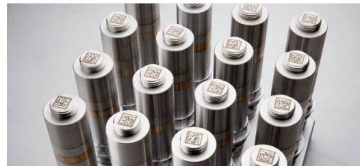
<p>Die Beschriftung der Bauteile mit Matrix Codes dient der internen Rückverfolgung von Prozessschritten.</p>
