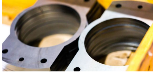
Thomas Sattler: „Das Verhältnis von Bohrungsdurchmesser zu Blechdicke ist klasse und macht die bisher häufig notwendige Fräsnacharbeitung überflüssig. (Foto: Thomas Abé)
