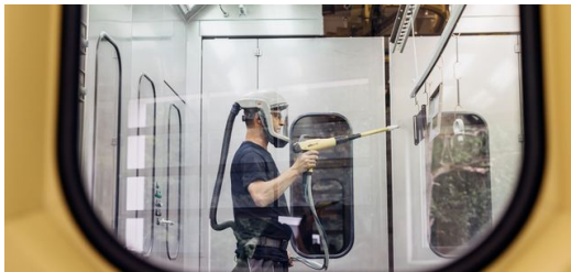
<p>Das Pulverbeschichten der Gehäuse übernimmt das Familienunternehmen ebenfalls selbst.</p>
