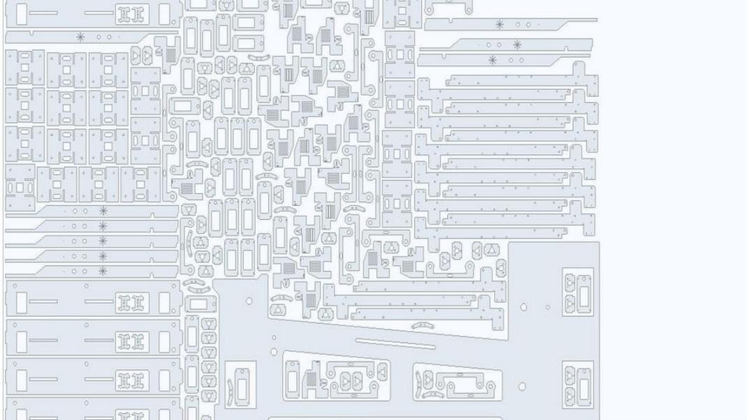
Beim „Nesting“ setzt der Mitarbeiter die Bauteile wie bei einem Puzzle virtuell am Computer auf die Blechplatte. Das Ziel ist es, so viele Teile wie nötig aus der Tafel herauszubekommen. Anschließend schneidet die Maschine mit einem Laser die Teile aus.
