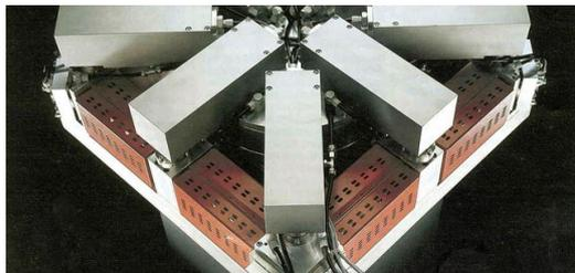
1985 präsentiert TRUMPF einen gefalteten Hochleistungs-CO<sub>2</sub>-Laser - die Basis für die heutigen Multikilowatt-Laser.
