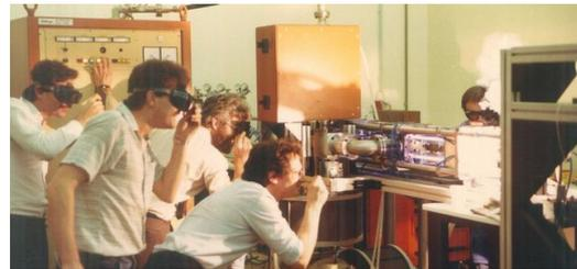
1985 baut TRUMPF seinen ersten eigenen CO<sub>2</sub>-Laser, den TLF 1000. Er hat eine Laserleistung von 1 Kilowatt.
