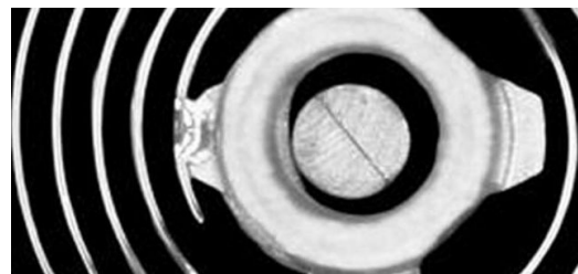
Der Schweißpunkt hat einen Durchmesser von 0,2 Millimetern
