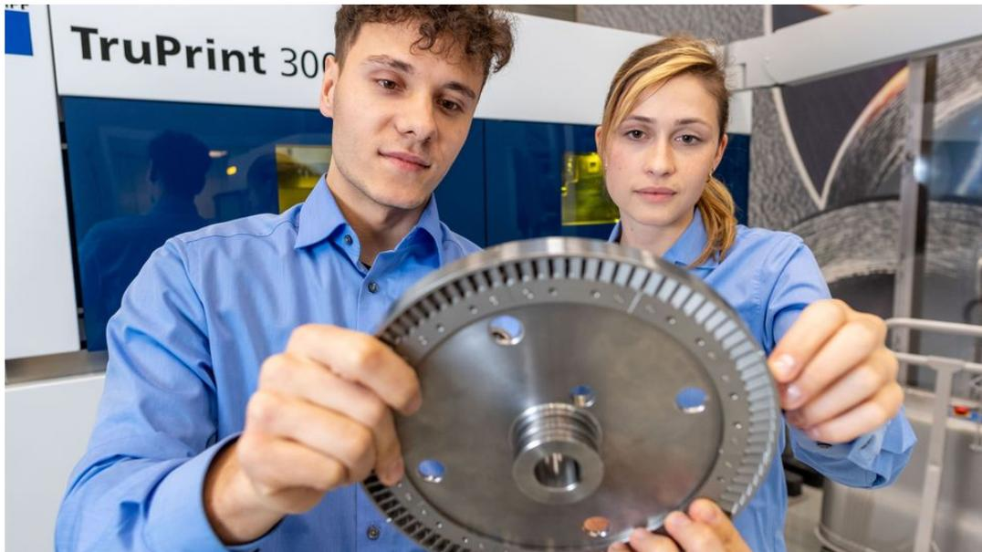
Mit konventionellen Verfahren sind für dieses Turbinenschaufelrad 90 Einzelteile notwendig. Dank 3D-Druck lässt es sich am Stück herstellen. Das spart Zeit, Material und Kosten.
