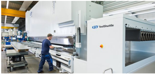
Das leichte und ergonomische Arbeiten ermöglicht der an der VarioPress angeschlossene Werkzeugspeicher ToolShuttle. Im ToolShuttle lagern die zwei Biegestempel, die 99 Prozent der Kantvorgänge bei Schrag abdecken. Bild: Dirk Egelkamp
