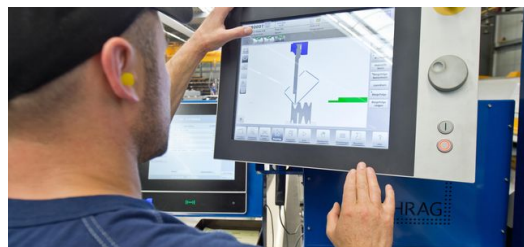
<p>Über den hochauflösenden 17-Zoll-Color-Touchscreen-Flachbildschirm der Maschinensteuerung lassen sich 2D- und 3D-Programmierungen ebenso wie 3D-Simulationen aufrufen. „Die Handhabung der neuen
