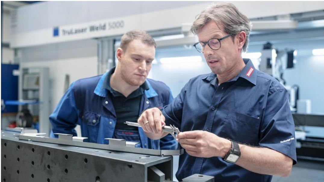
Beim Tiefschweißen mit dem Laser ist die Wärmeeinwirkung weitaus geringer als bei konventionellen Schweißverfahren – und damit auch der Verzug. Josef Böhmer (rechts): „Vor allem im Schalungsbau sind die Teiletoleranzen mittlerweile sehr eng, es spart uns also eine Menge Zeit, wenn wir auf das anschließende Richten verzichten können.“
