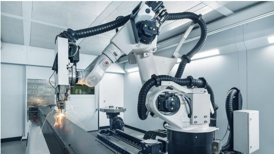
Die Großformatmaschine TruLaser Weld 5000 bei Böhmer Systemtechnik ist mit einem Kuka-Roboter auf der Linearachse und einem Wendepositionierer ausgestattet. So lässt sich ein Arbeitsraum von vier Metern Länge und 1,50 Meter Breite abdecken. Beim Schweißen kleiner Teil zwischendurch bringt der Dreh-Kipp-Positionierer Flexibilität.
