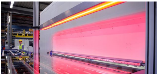
Eine weniger als 100 Mikrometer dünne Laserlinie erhitzt die Funktionsbeschichtung von Glasplatten ganz kurz auf über 500 Grad. Bild: Ralf Kreuels
