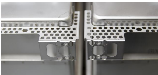
Umformungen wie Laschen, Gewinde oder Scharniere werden jetzt schnell und einfach auf der TruMatic 6000 fiber gefertigt. (Foto: Claus Langer)
