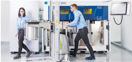
Mitarbeiter holen den Zylinder mit dem Bauteil aus dem 3D-Drucker zur Weiterverarbeitung. – Clauss Morgenstern
