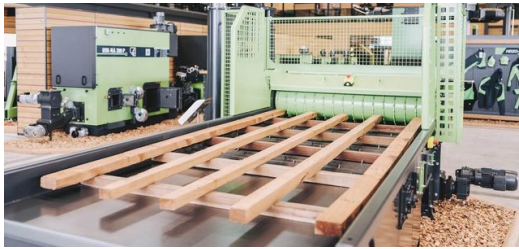
<p>Palettenhacker: Aus Abfallpaletten entsteht wertvoller Brennstoff.</p>
