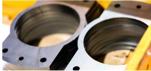
Thomas Sattler: „Das Verhältnis von Bohrungsdurchmesser zu Blechdicke ist klasse und macht die bisher häufig notwendige Fräsnachbearbeitung überflüssig. (Foto: Thomas Abé)
