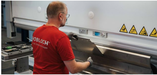
<p>An der manuellen Biegemaschine TruBend 5130 bearbeitet ein Mitarbeiter Blechteile für Briefkastenanlagen und Sonderanfertigungen.</p>
