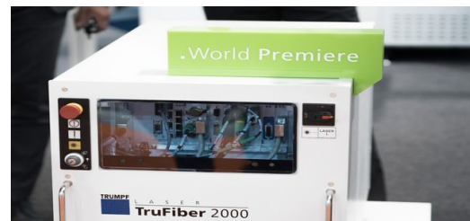
Der faserbasierte Festkörperlaser TruFiber 2000 feierte auf der LASYS 2018 Weltpremiere. Auch er trägt durch den kompakten Laseraufbau und den flexiblen Schnittstellen zu allen gängigen Feldbusssystemen und der höchstmöglichen Lasersicherheits-Klassifizierung mit Performance Level e zu einer einfachen Integration bei. Foto: Lorenz Buchwald
