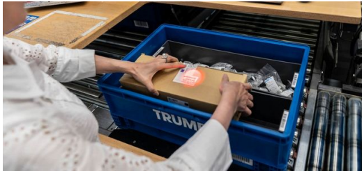
<p>Digitale Hilfestellung: Eine farbige Lichtmarkierung zeigt den Mitarbeitern an, welche Bauteile sie in welche Kiste legen sollen.</p>
