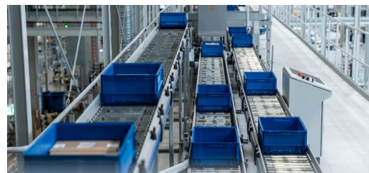
<p>Bis zu 120 Kisten kreisen gleichzeitig in fünf Metern Höhe über der Werkhalle und transportieren die Ersatzteile an die verschiedenen Stationen.</p>
