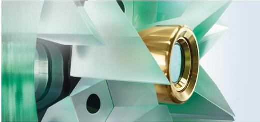
Blick in den Laserresonator: Die Umlenkspiegel in der Kavität lenken den Pumpstrahl, der von den Dioden kommt, mehrmals durch den Scheibekristall. So entsteht ein gebündelter Laserstrahl. Bild: TRUMPF
