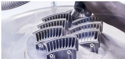
Binnen Minuten befreit ein Vakuumsauger das Bauteil von überschüssigem Pulver. (© Clauss Morgenstern)
