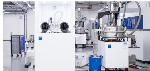
Das überschüssige Pulver wandert von der Entpackstation (links) in die Siebstation. Diese säubert das überschüssige Pulver von Schmutz und Schmutzpartikeln aus dem Schweißprozess, sodass es sich wiederverwenden lässt. (© Clauss Morgenstern)
