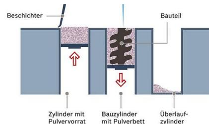
Funktionsprinzip von Laser Metal Fusion.
