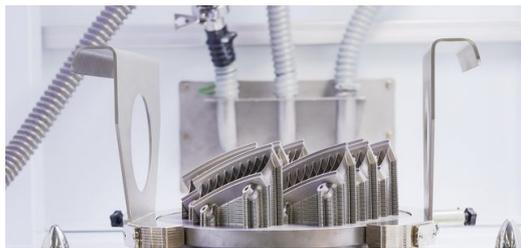
Auftrag abgeschlossen: Das Bauteil kommt fertig aus dem Drucker. (© Clauss Morgenstern)
