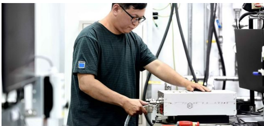
<p>Generatoren von TRUMPF zähmen den Strom und stellen Stromstärke, Spannung und Frequenz auf einen hochpräzisen Wert ein.</p>
