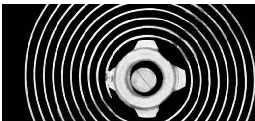
Eine der ersten industriellen Anwendungen für Laser: lasergeschweißte Uhrfeder.
