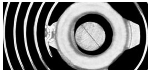
Der Schweißpunkt hat einen Durchmesser von 0,2 Millimetern
