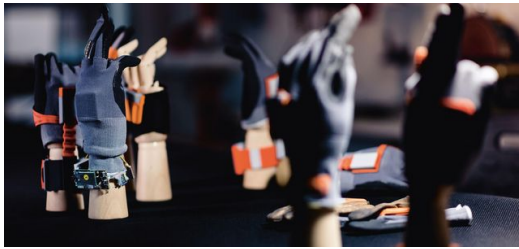
ProGlove setzt auf intelligente Handschuhe. Smart-Glove "Katharina" zeigt an, ob die Mitarbeiter Arbeitsschritte richtig ausführen. Modell "Mark" reduziert Fehler, die zum Beispiel beim Kommissionieren entstehen. Vom intelligenten Handschuh können alle industriellen Bereiche profitieren die logistische Abläufe bewältigen müssen. (Foto: ProGlove)
