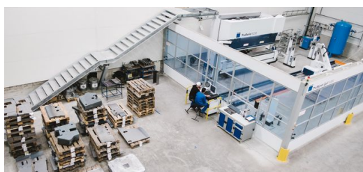
Die TruBend Cell 5000 verfügt über eine Presskraft von 230 Tonnen. Bauteile von 3000 x 1500 Millimeter lassen sich bequem darauf bearbeiten.
