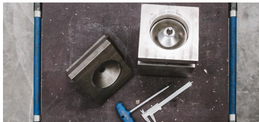
Das von TRUMPF in Pasching speziell für PNH angefertigte Sonderwerkzeug ermöglicht das automatische Einbringen von halbmondförmigen Vertiefungen für die Kesselblechfertigung.
