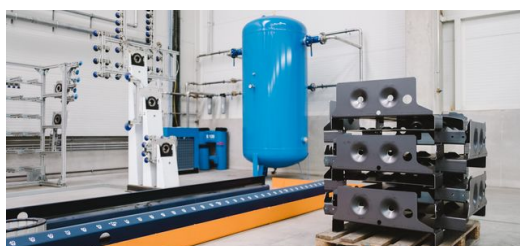
Die Bearbeitung großer und schwerer Teile mit Gewichten zwischen 60 und 80 Kilogramm sind bei PNH an der Tagesordnung. Um seine Mitarbeiter zu schonen hat Martin Mitterhumer seine Anlage mit Vakuum- und Zangengreifern ausgestattet.
