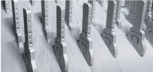
Das 3D-Druck-Verfahren erlaubte es den jungen Ingenieuren von UrbanAlps, die Form von Schlüsseln völlig neu zu denken. Bild: UrbanAlps
