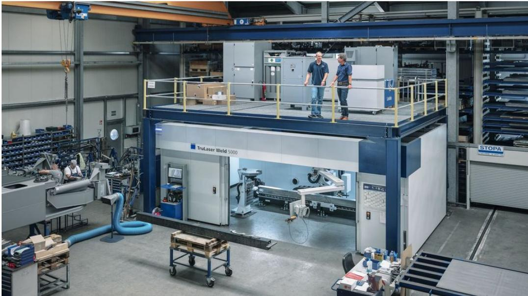
Um Platz zu sparen, sind die komplette Peripherie sowie die Anlagentechnik der TruLaser Weld 5000 auf einer Umhausung oberhalb der Maschine positioniert.
